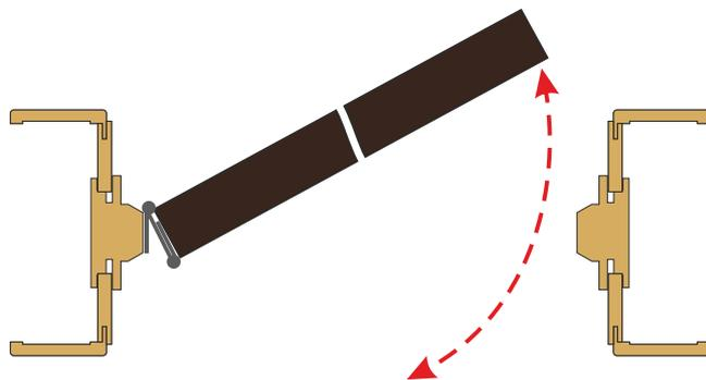
высота полотна = высота проема -80...100 мм
